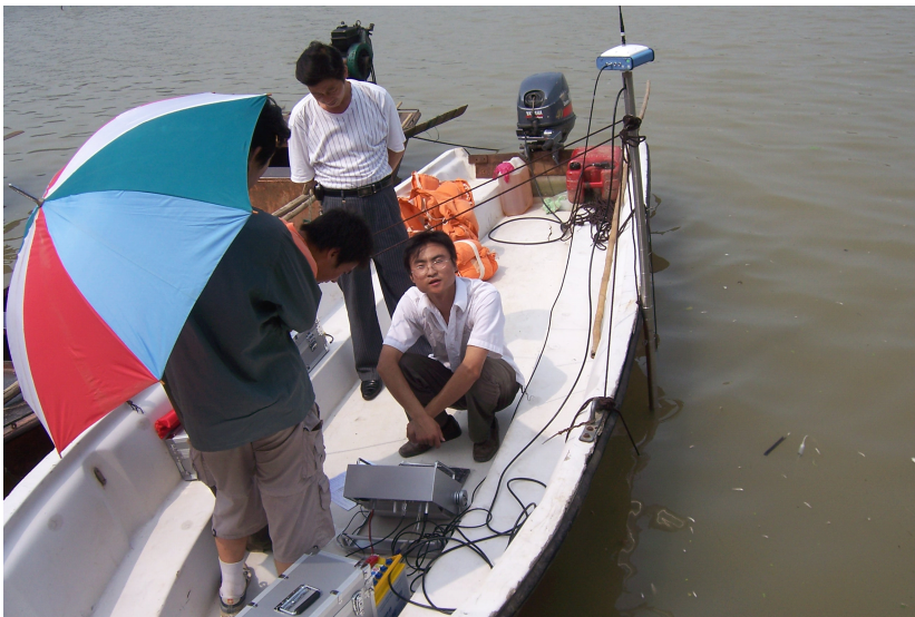
图 10-2 S86 水上测量系统的连接
